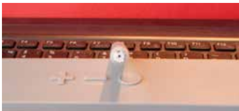
Рис. 6в. Геофизический кабель по рисунку 4. Торец. В центре отверстие 0,9 мм. Волокна не видны
