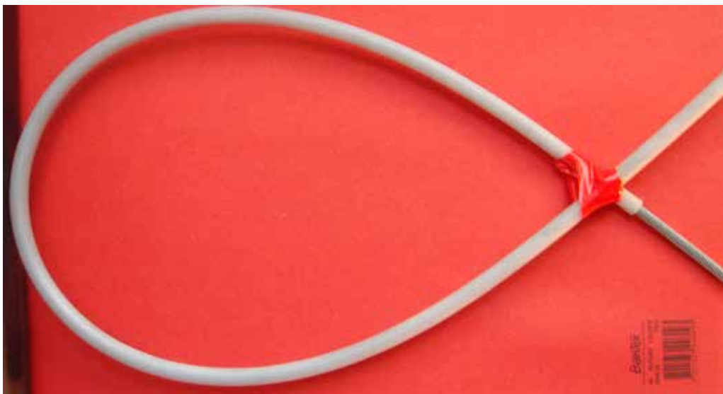
Рис. 6б. Кабель изогнут с радиусом 100 мм
