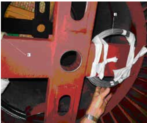
Рис. 4. Электрооптический кабель на барабане рядом со скважиной. На рисунке 1- электрические жилы, 2- 50 м бухты оптического кабеля (нижний конец), отделённого от общего кабеля для прокладки в измерительную лабораторию.
